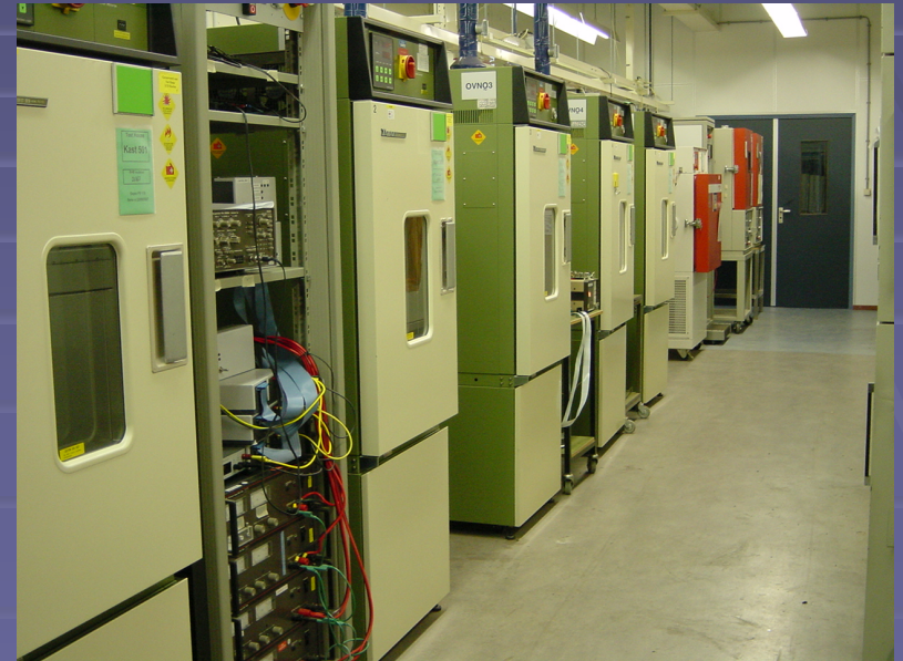
Mehrere Klimaschränke zur Bauteilekontrolle werden von nur einem Messrechner überwacht (Holland)
