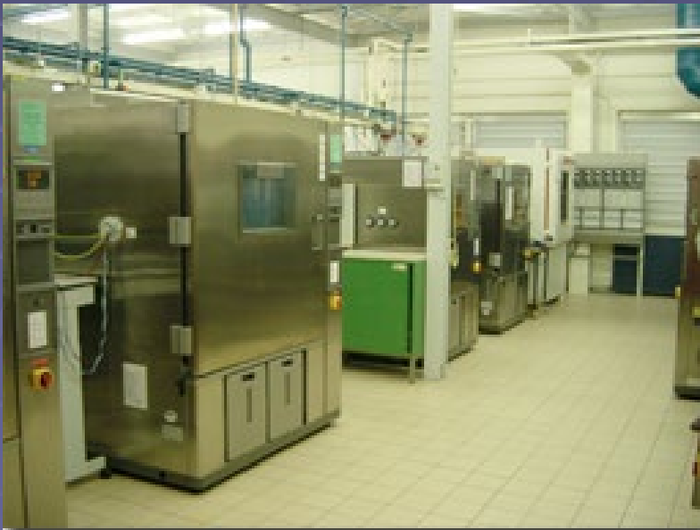
Mehrere Klimaschränke zur Bauteilekontrolle werden von nur einem Messrechner überwacht (Holland)
