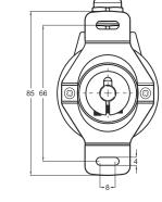
Push-Pull Cable Output +V : Brown 0V : White GND : Shield Ch A : Yellow Ch B : Green Ch Z : Gray
