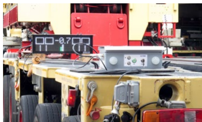
Ideal für Schwertransporte: Die LED-Großanzeige mit automatischer Helligkeitsregelung ist in einer Distanz von bis zu 20m gut ablesbar.
